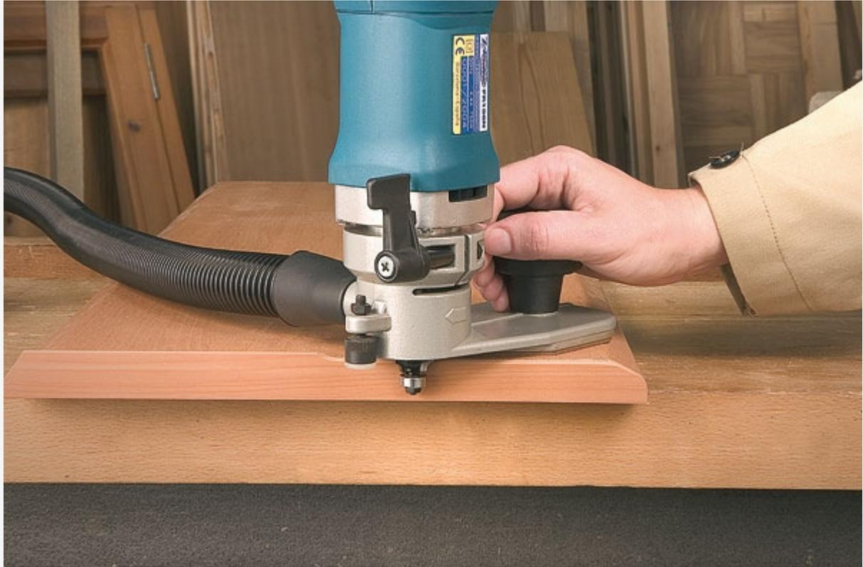
La tête CA56G permet l'affleurage ininterrompu des quatre chants d'un panneau. Elle dispose d'une grande base d'appui et d'un bouton auxiliaire pour la fixation qui lui confère une parfaite stabilité. C'est l'outil idéal pour la réalisation de travaux d'arasage, sur le bord du panneau et au centre.
