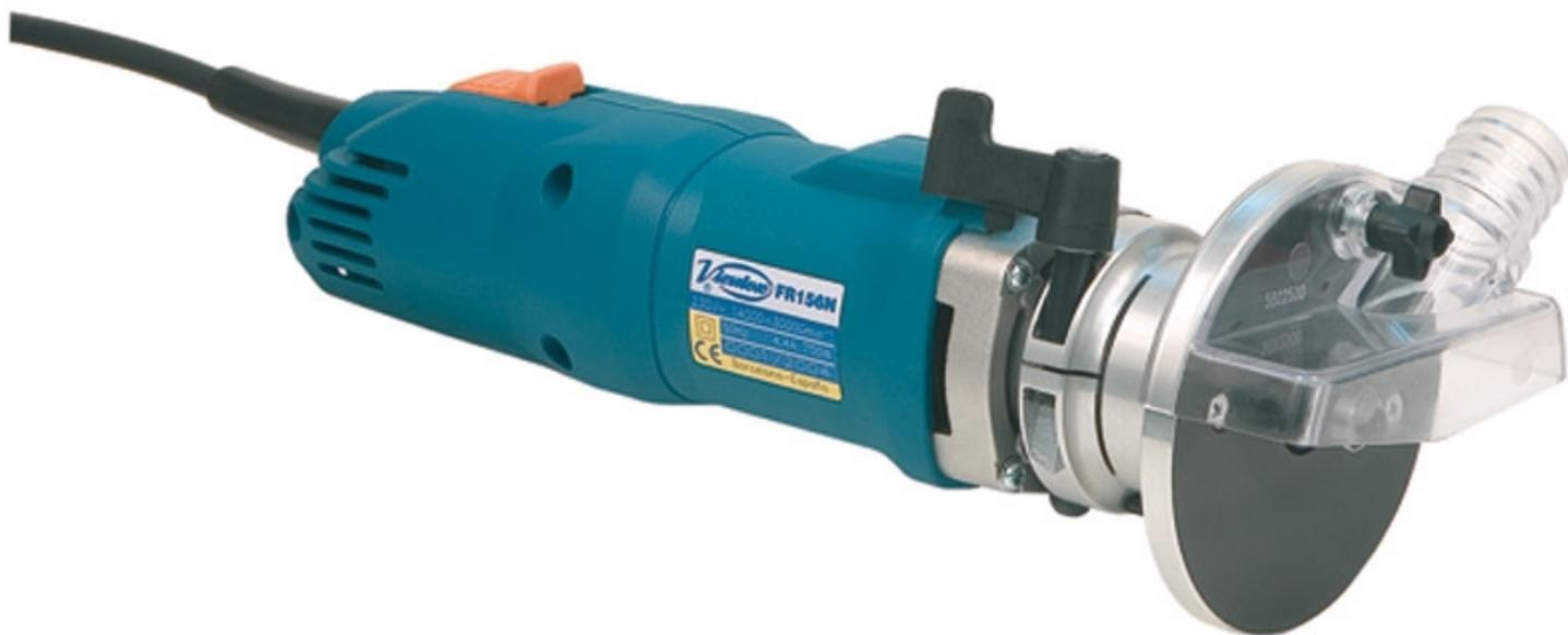
Machine spécialement conçue pour l'affleurage des chants PVC-3 mm et autres matériaux. Possibilité d'affleurer les chants d'épaisseurs supérieures à 3 mm en utilisant d'autres fraises en option. Équipée d'une fraise carbure avec roulement  $r=3$  mm et buse d'aspiration.
