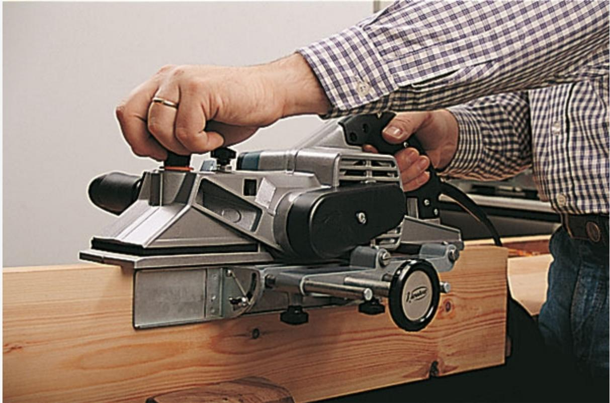
Équerre micrométrique permettant de réaliser des chanfreins réglables.
