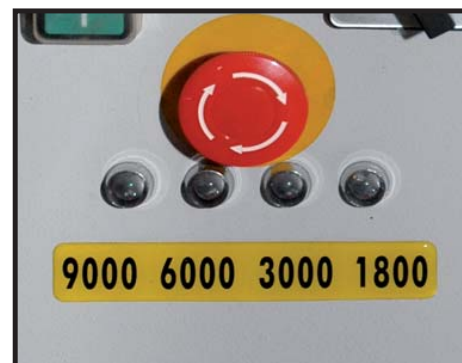
Toupie avec 4 vitesses de rotation Spindle moulder with 4 speed
