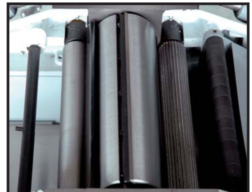
Rouleaux d'entraînement ø 40 mm pour l'avance de la pièce de bois Arbre de 95 mm à 4 fers Automatic feed system. Planer shaft 95 mm with 4-knives
