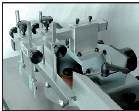
Guide de toupie avec presseur horizontal et vertical Spindle guide with horizontal and verical vise
